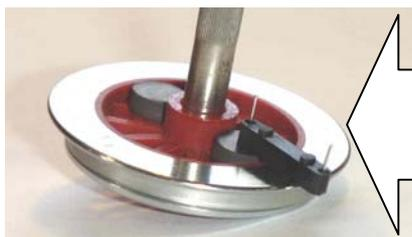
Nebenstehende Abbildung zeigt wie die Magnete für das Auslösen des Dampfstoßes an einem LGB Rad angebracht werden können, sowie die Lage des Reedkontaktes.
